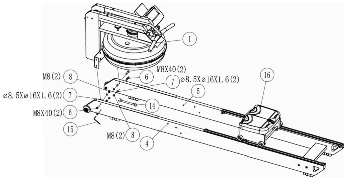
Paso 2: Coloque la pieza 16 sobre la pieza 4 y la pieza 5, coloque la pieza 1 sobre la almohadilla de espuma de la pieza 4 y la pieza 5, alinee los orificios de montaje.
