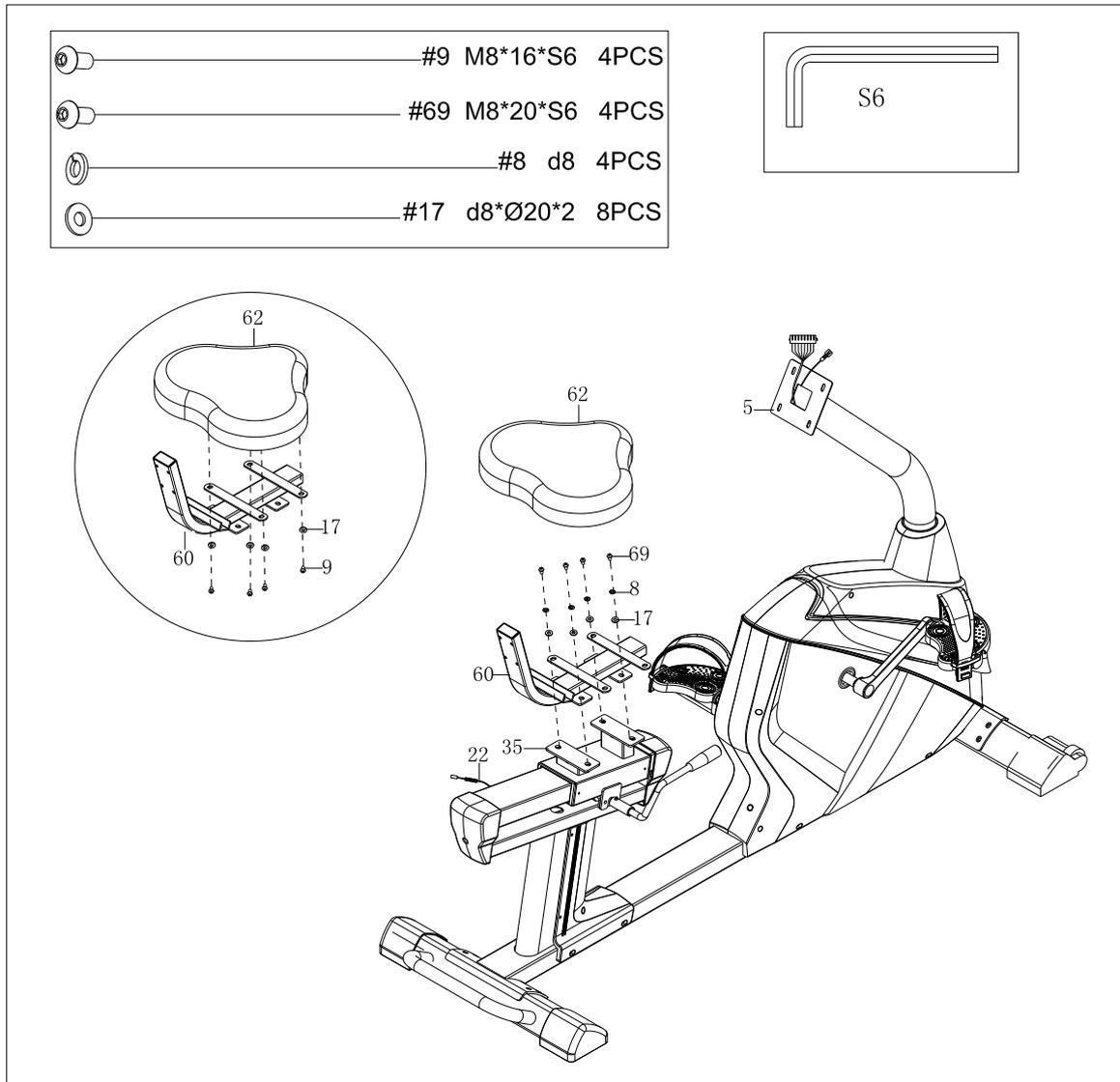
a. Enlever les boulons (69), les rondelles élastiques (8) et les rondelles (17) du segment de soutien du siège (35) avec la clé (66), puis fixer l'assemblage du cadre de la selle (60) au segment de soutien du siège (35) avec la clé (66), le boulon (69), les rondelles élastiques (8) et la rondelle (17).
