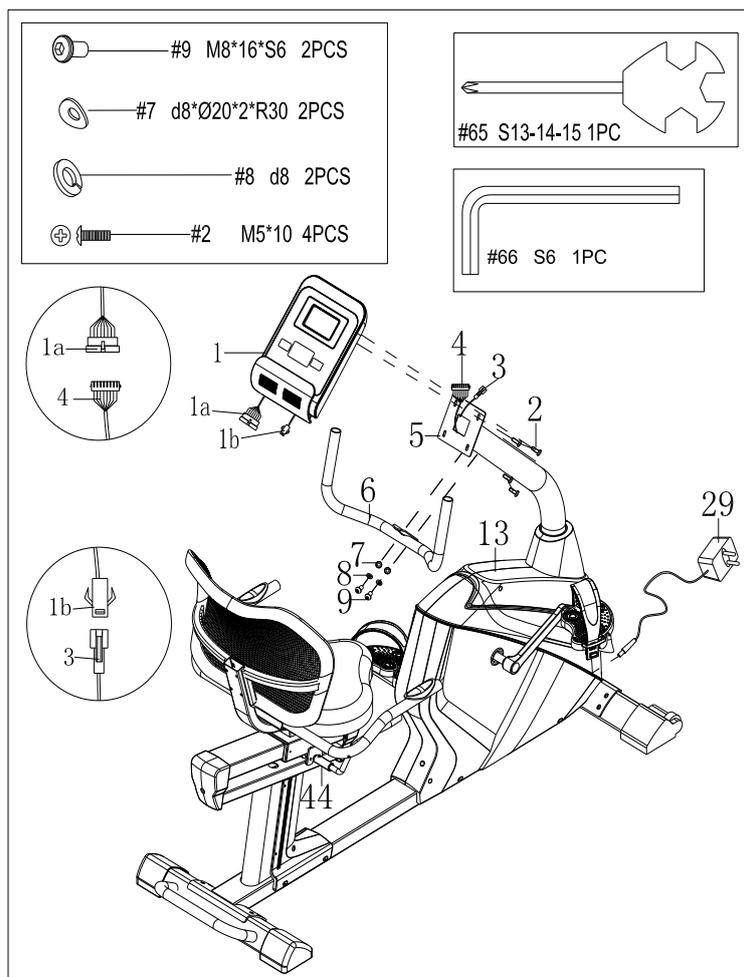
a. Connecter correctement le câble de l'ordinateur (1a) et le câble 1 (4) ; connecter
