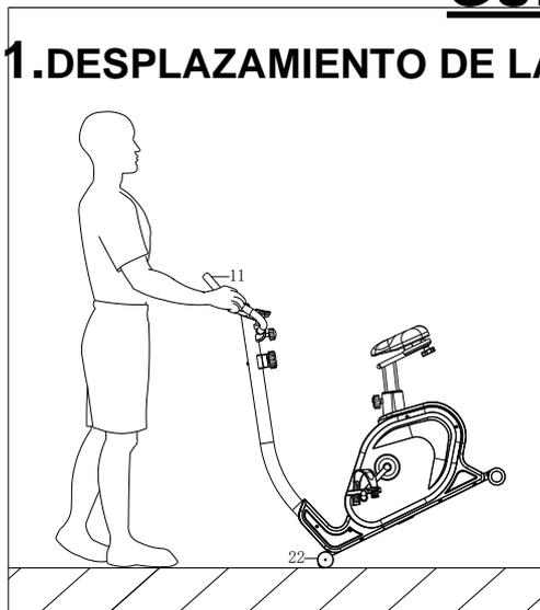
Para mover la máquina, empuje la barra (11) hasta que la cubierta final de las ruedas de transporte (22) en el estabilizador delantero toquen el suelo. Con las ruedas en el suelo, puede transportar la bicicleta al lugar deseado con facilidad.
