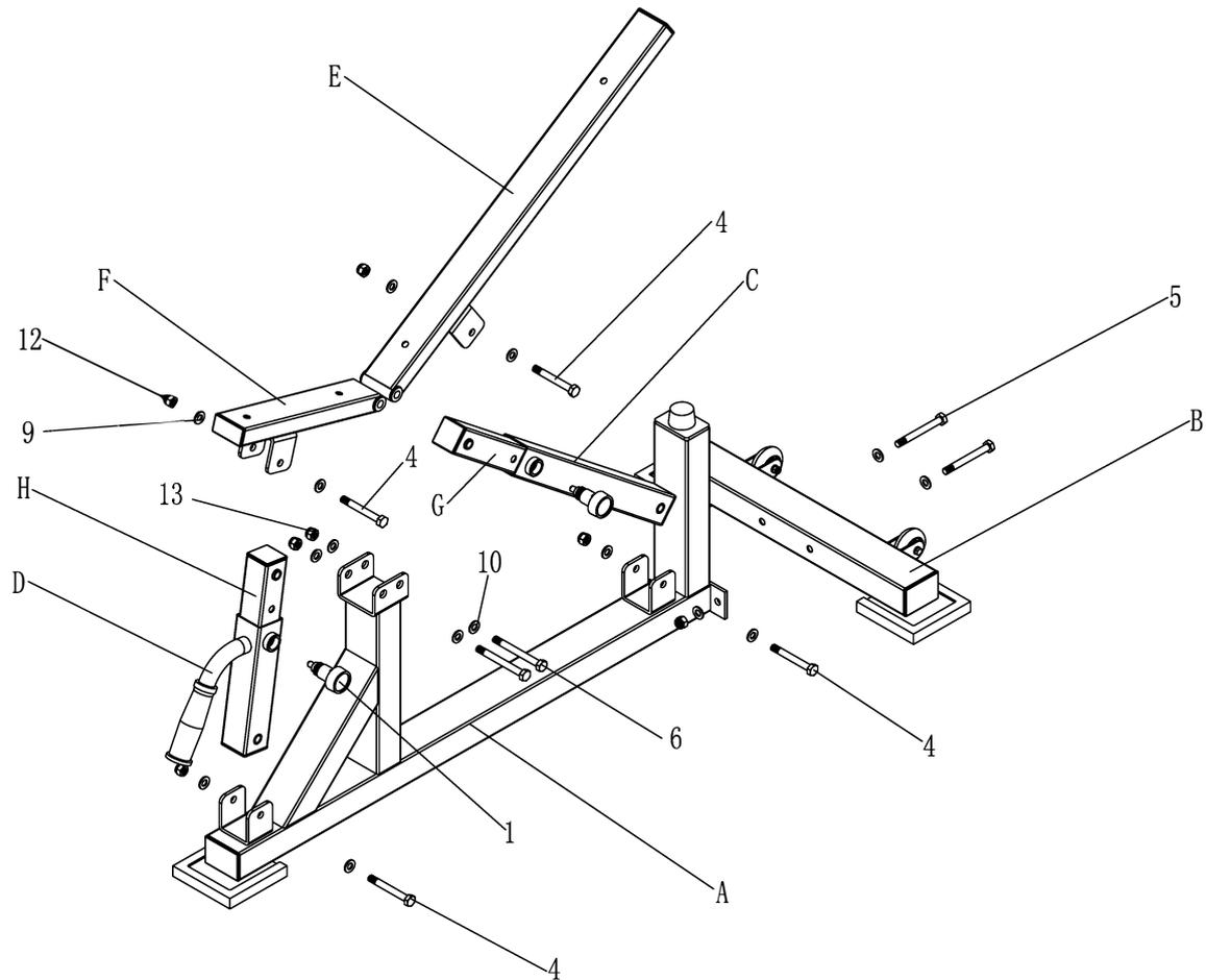
1. Assembler **(B)** sur **(A)** à l'aide du boulon M10\*90(**5**) + rondelle 10(**9**) + écrou de blocage M10(**12**).
