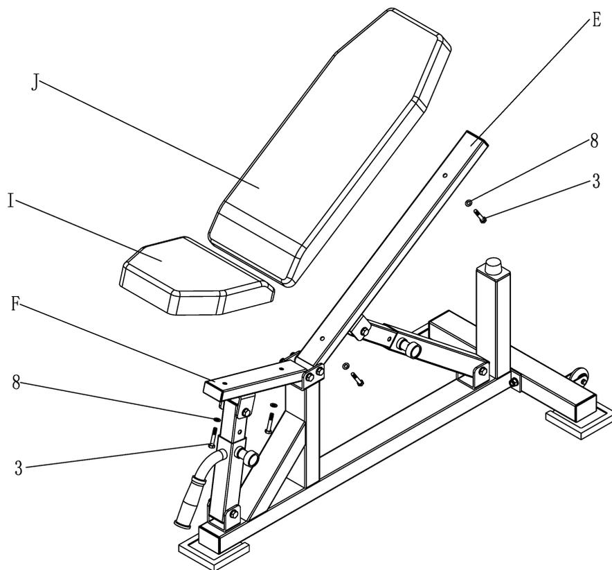
1. Assembler (J) sur (E) avec le boulon M8\*45(3) + rondelle 8(8).
