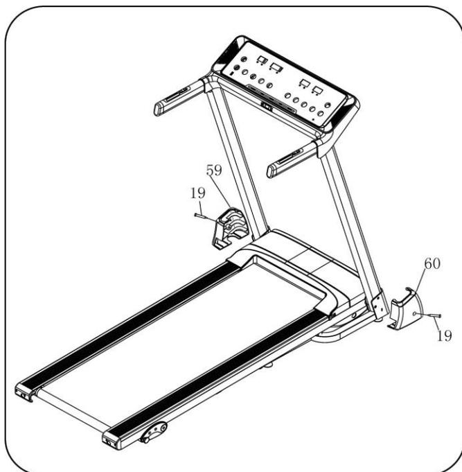
Utiliser une clé avec un tournevis (78) pour bloquer le couvercle de la base gauche (59) sur le cadre de base avec le boulon (19).
