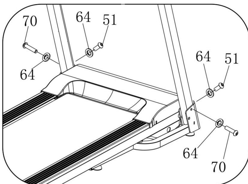
1. Utiliser une clé Allen 5#(12) , Bloquer d'abord le montant droit sur le cadre de base avec le boulon (70) et la contre-clé ( 64 ) , puis bloquer le montant droit sur le cadre de base avec le boulon (51) et la contre-clé (64).
