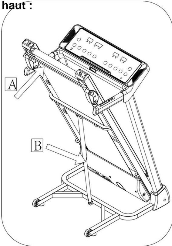
Tirer le cadre de base en position A, jusqu'à entendre le bruit signalant que la barre de pression d'air B est bloquée dans le tube rond
