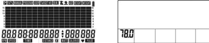
A-1. Sie können durch Drücken der Tasten UP (HOCH) und DOWN (RUNTER) unter folgenden Trainingsarten auswählen: MANUAL (MANUELL), PROGRAM (PROGRAMM), USER (BENUTZER) oder TARGET H.R. (ZIEL-HERZFREQUENZ) (a1).
